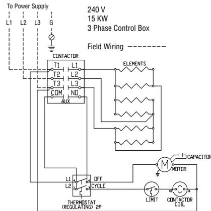
**Wiring Diagram 1 - 240V / 15KW, 3 Phase**
