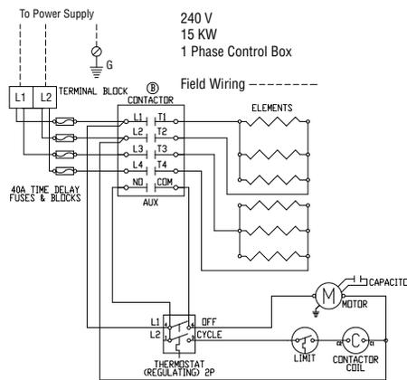
**Wiring Diagram 2 - 240V / 15KW, 1 Phase**
