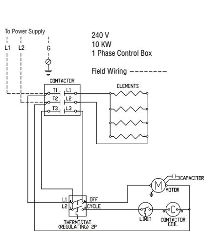
**Wiring Diagram 4 - 240V / 10KW, 1 Phase**
