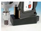
A fin de garantizar una alineación óptima también bajo condiciones adversas, la máquina MAB 845 está equipada con un dispositivo de giro adicional. Cuando el pie magnético está encendido, este dispositivo permite girar 30° hacia ambos lados y desplazar 20 mm hacia delante y hacia atrás la parte superior de la máquina.
