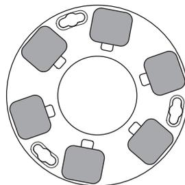
Al cambiar la manera de configurar los diamantes en los discos de fijación de diamantes, un operador puede influir significativamente en las prestaciones de la máquina y, por lo tanto, en el producto acabado.
