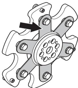
Disponemos de repuestos de los muelles de acero de resorte y se pueden sustituir sin necesidad de deshacerlos del cabezal desbastador.
