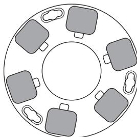
Une modification de la configuration des diamants sur les disques permet à l'opérateur d'altérer considérablement les performances de la machine et donc du produit fini.
